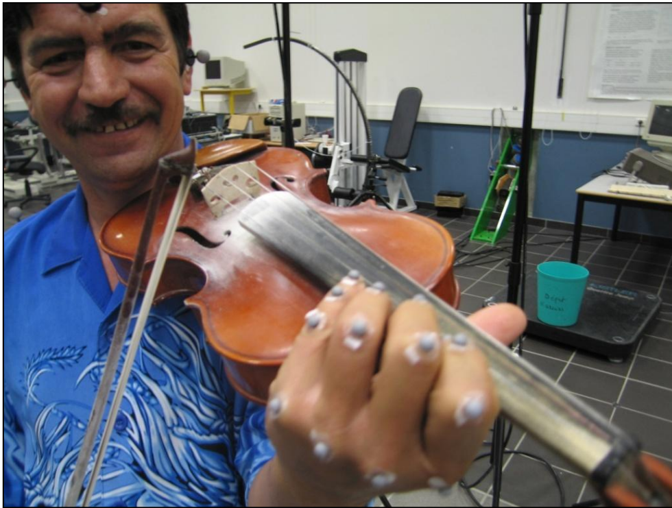
Figure 63 : Des capteurs plus petits ont été positionnés sur la main gauche du violoniste Sanyi pour l'étude de la douceur des doigts.
