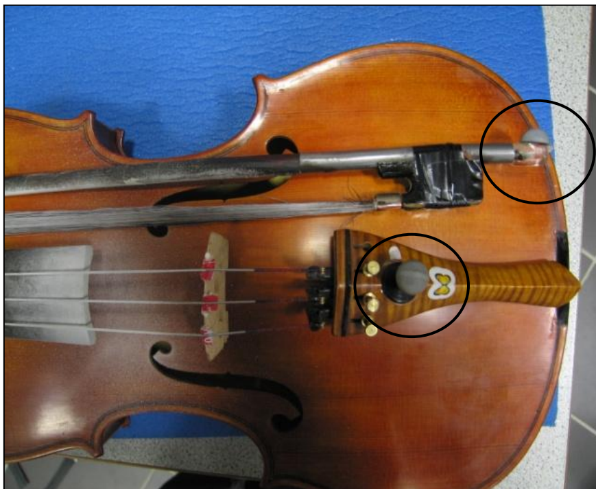
Figure 53 : Les marqueurs retro-réfléctifs placés sur le violon et l'archet.
